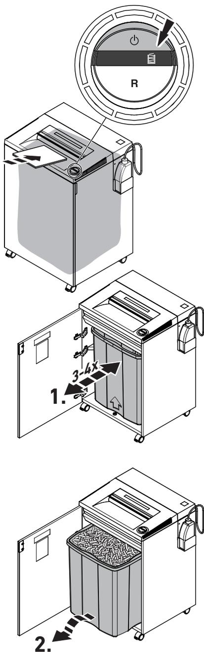
**DE Anzeige „Schnittgutbehälter voll“
