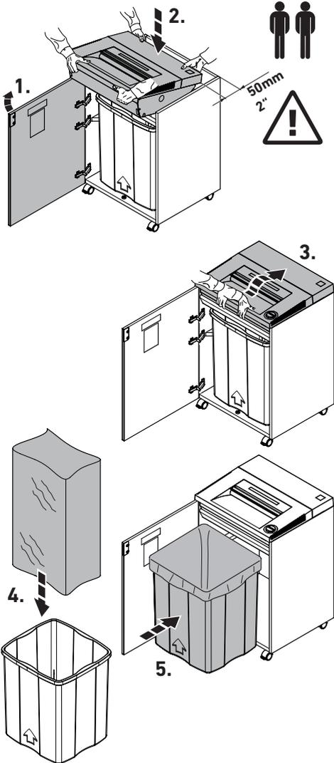
**ES** Abrir la puerta. Colocar el cabezal de la máquina sobre el armario base con 2 personas (véanse imágenes).
