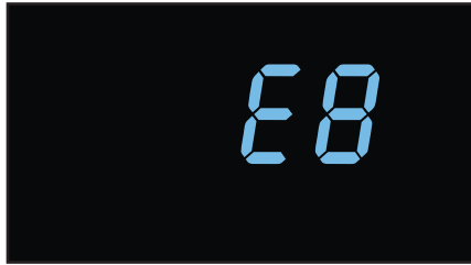
EB ( Batería Externa)
