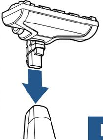
Assurez-vous que l'aspirateur est hors tension (OFF). Appuyez sur le bouton de dégagement pour détacher la buse pour plancher amovible de l'aspirateur à main.
