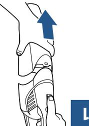
Eteignez l'aspirateur et maintenez-le en position verticale en appuyant sur le bouton de relâchement du réservoir à poussière. Retirez délicatement le réservoir à poussière de l'aspirateur à main.
