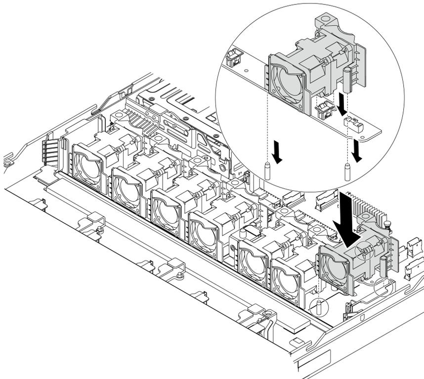
*Figure 82. System fan installation*
