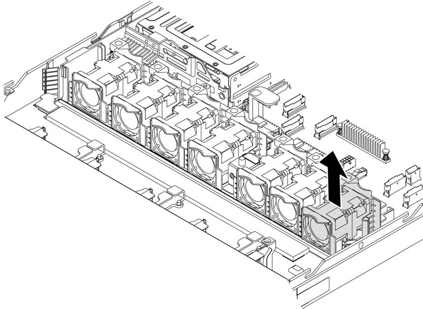
Figure 81. System fan removal
