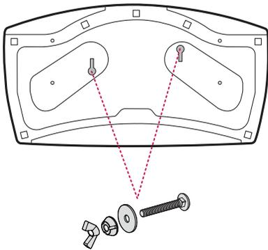
2 vis pour la fixation du socle,
