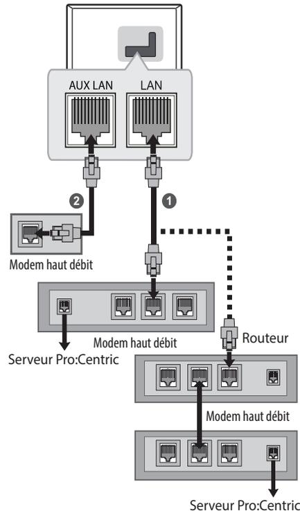
**1** Raccordez le port **LAN** du modem ou du routeur au port **LAN** du téléviseur.
