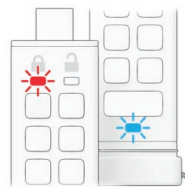
赤と青が同時に点滅する USB ポートに接続されていない場合は、ユーザー PIN と管理者 PIN の両方が datAshur PRO+C に設定されています
