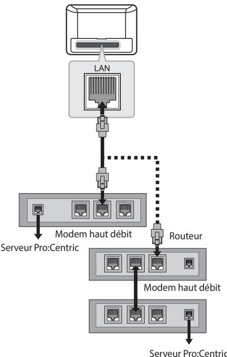
Raccordez le port **LAN** du modem ou du routeur au port **LAN** du téléviseur.
