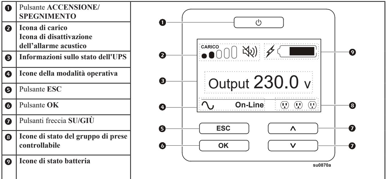
La data di installazione della batteria apparirà sull'interfaccia del display entro due minuti dall'installazione. Se la data di installazione non appare sull'interfaccia del display, utilizzare i pulsanti freccia SU/GIÙ per navigare nel **menu di configurazione > Batteria** e inserire la **Data di installazione** corretta.
