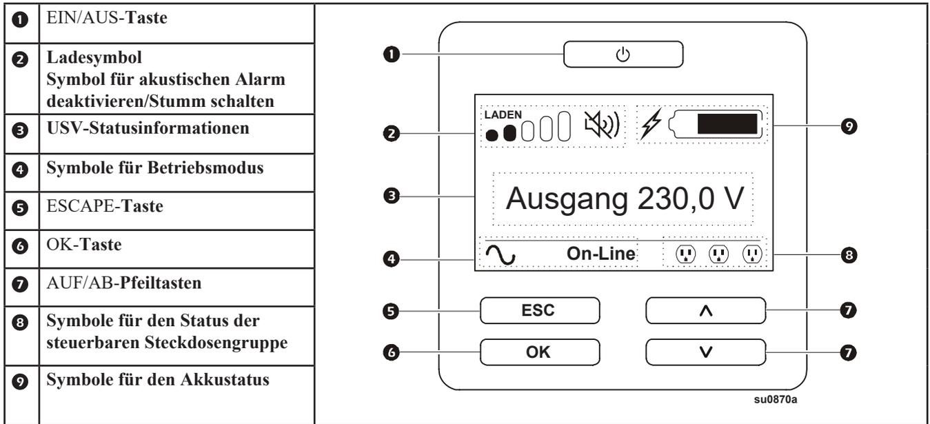
Das Datum der Akkuinstallation wird innerhalb von zwei Minuten nach der Akkuinstallation auf der Displayoberfläche angezeigt. Wird das Installationsdatum nicht auf der Displayoberfläche angezeigt, nutzen Sie die AUF/AB-Pfeiltasten, um zu **Config Menu (Konfig.-Menü) > Battery (Akku)** zu navigieren und geben Sie das korrekte **Installation Date (Installationsdatum)** ein.
