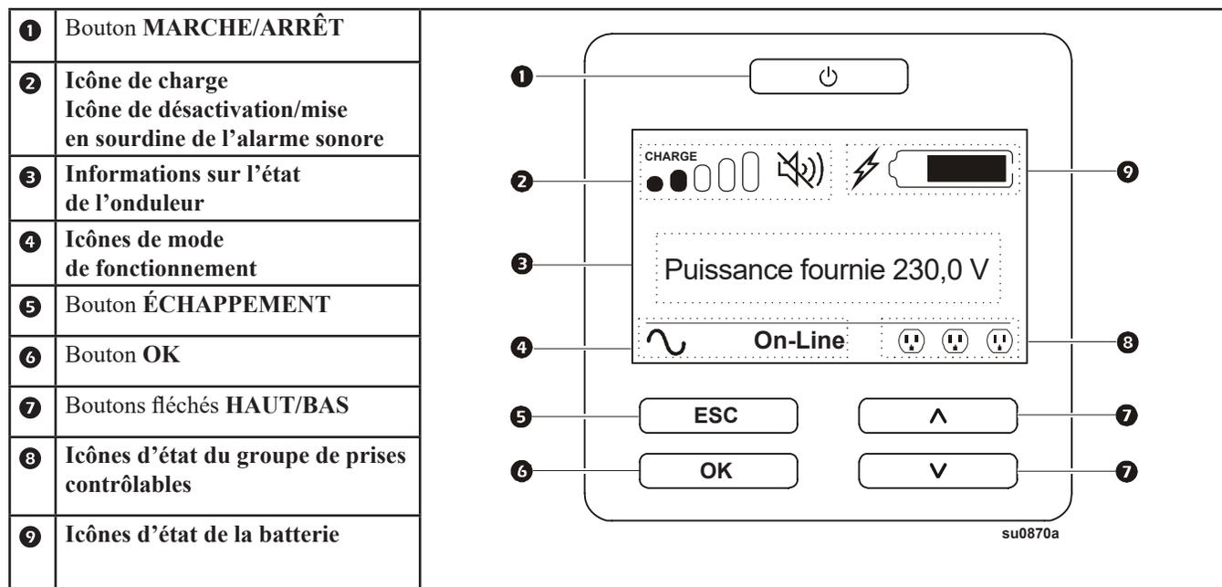
La date d'installation de la batterie apparaît sur l'interface d'affichage dans les deux minutes suivant l'installation de la batterie. Si la date d'installation n'apparaît pas sur l'interface d'affichage, utilisez les boutons fléchés HAUT/BAS pour accéder au **menu Config > Batterie et saisissez la Date d'installation correcte.**
