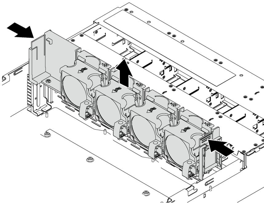
Figure 54. System fan cage removal
