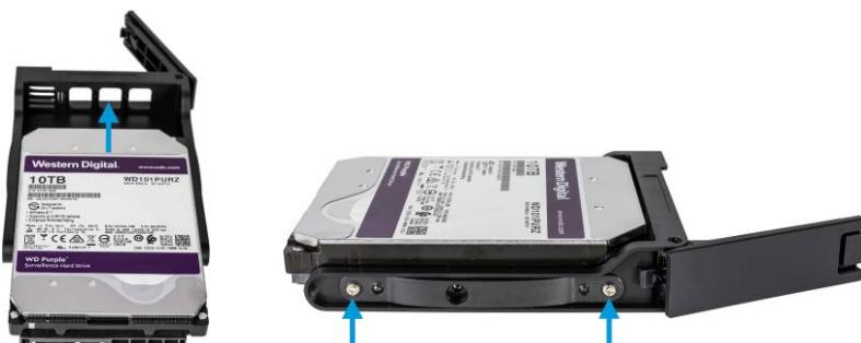
2. Verwenden Sie die beiliegenden Schrauben zur Befestigung der Festplatte an der Ablage an vier Stellen, zwei Schrauben an jeder Seite.
