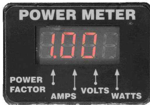
Power Meter Display
