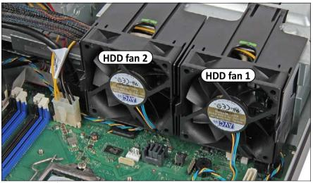
Figure 68: HDD fan position
