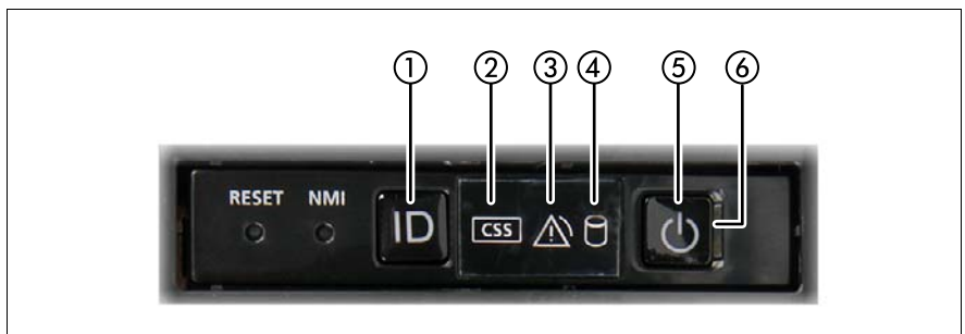
Bild 14: Anzeigen am Frontpanel
