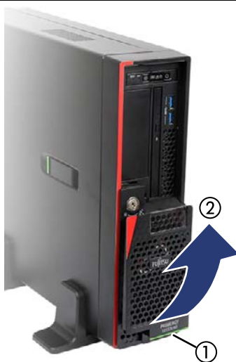
Bild 11: Laufwerksabdeckung von der HDD-Abdeckung entfernen
