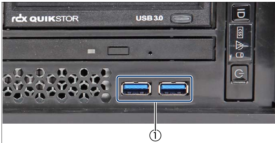
Bild 6: Anschlüsse an der Frontseite
