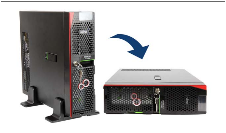
Bild 5: Server waagerecht aufstellen
