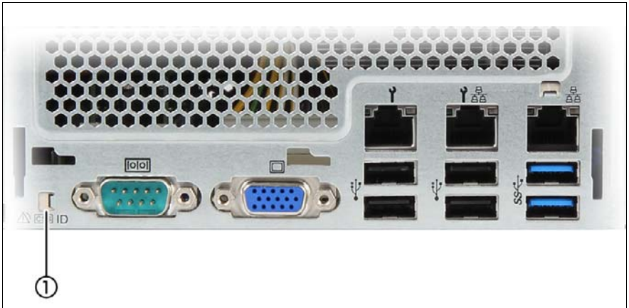
Bild 17: Anzeige am Anschlussfeld: CSS-, Global-Error- und ID-Anzeige
