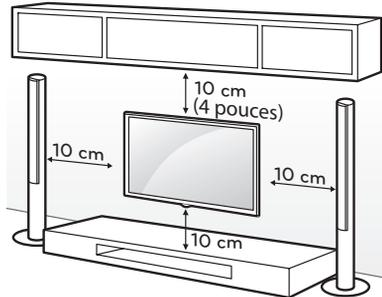
Assurez-vous d'utiliser les vis et les fixations murales qui répondent aux normes VESA. Les dimensions standards des trousse de fixation murale sont indiquées dans le tableau suivant.
