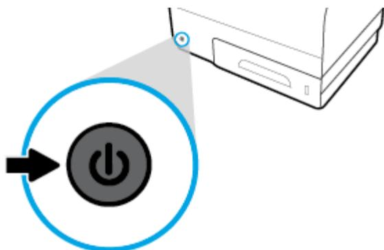
Un message d'avertissement apparaît sur le panneau de commande si vous essayez de mettre le produit hors tension lorsqu'une ou plusieurs cartouches manque(nt).
