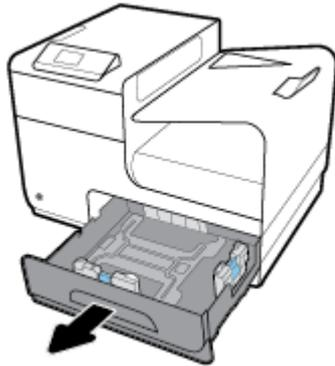
2. Placez les guide-papier (longueur et largeur) en position d'ouverture maximale.
