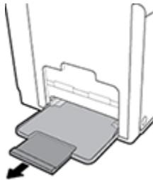
3. Placez les guide-papier en position d'ouverture maximale et chargez la pile de papier dans le bac 1.
