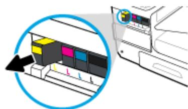
4. Ne touchez pas les contacts métalliques sur la cartouche. Les traces de doigts sur les contacts peuvent provoquer des erreurs de connexion.
