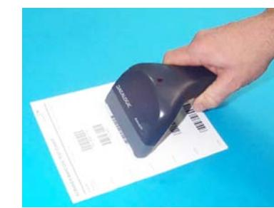
Avec les lecteurs Touch™ Pro, la lecture des codes s'effectue automatiquement et **par contact**. Tous les modèles sont doués d'un poussoir qui doit par défaut être appuyé pour lire le code. Après avoir configuré l'interface de lecture, on peut sélectionner le paramètre software trigger (disponible dans ce manuel) pour utiliser le lecteur comme un modèle sans poussoir.
