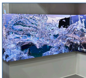
Innen- als auch Außeneckmontagen lassen sich problemlos umsetzen
