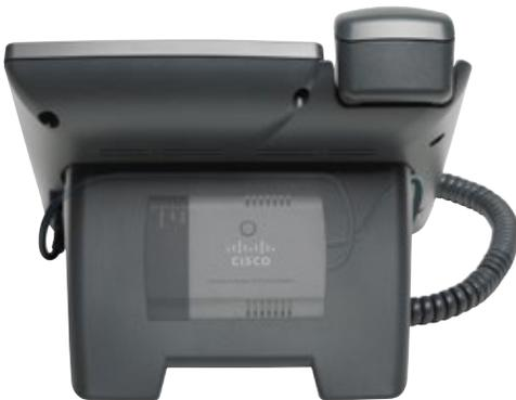
Cisco IP-Telefone der Serie SPA mit installierter Wireless-N Bridge für Telefonadapter
