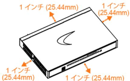
壁に取り付ける場合は、3M × 25 mm の長さのナベねじ (頭部直径 7 mm) を 2 本使用します。
