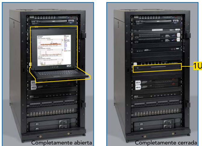
La consola de rack se dobla como una laptop y se desliza al interior de un cajón de rack de 1U.
