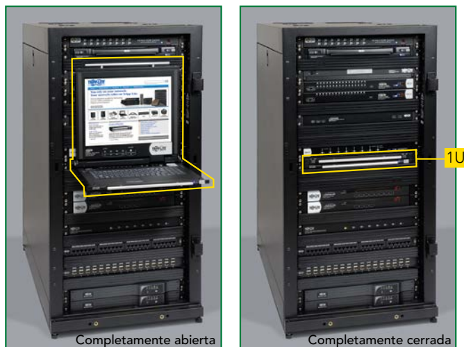
Los KVMs de Consola se doblan como una laptop y se deslizan al interior de una gaveta de rack de 1U.
