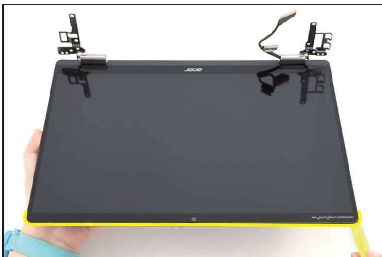
Figure 1-35. Retrait du panneau LCD
