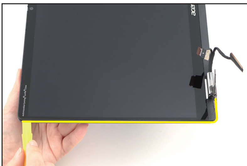
Figure 1-36. Retrait du panneau LCD
