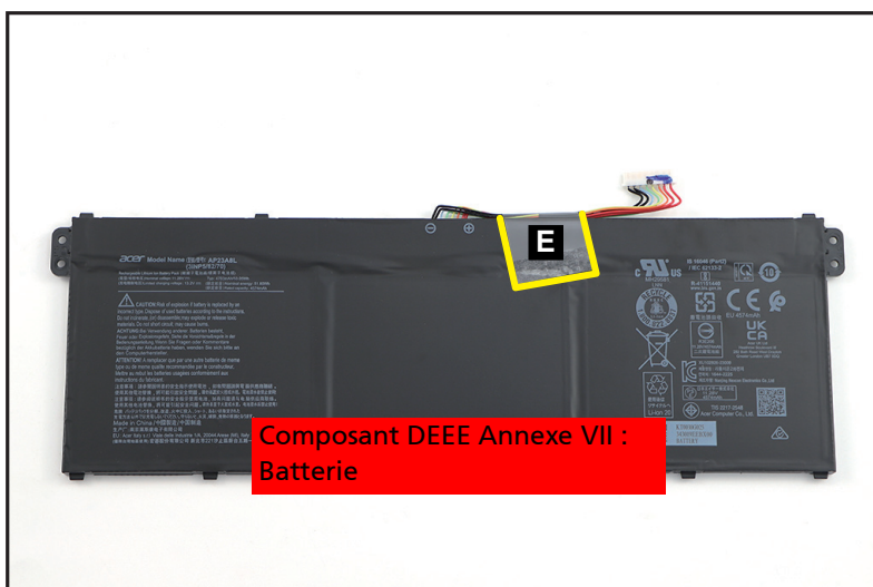
Figure 1-9. Retrait du batterie
