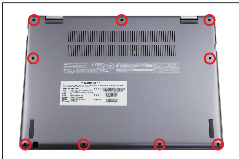
Figure 1-3. Retrait du couvercle de base
