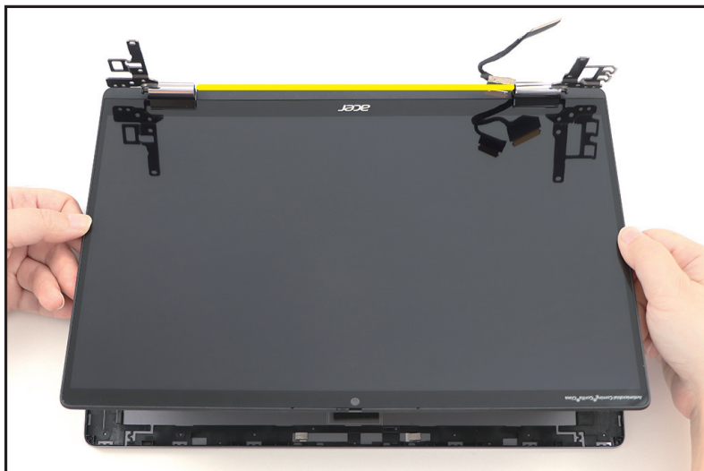
Figure 1-38. Retrait du panneau LCD
