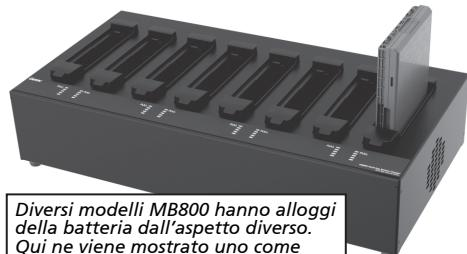
**AVVERTENZA:** Quando si inserisce o si rimuove la batteria, assicurarsi di farlo in posizione verticale verso l'alto o verso il basso. Non inserirlo o rimuoverlo mai in modo inclinato poiché ciò potrebbe danneggiare i pin del connettore.
