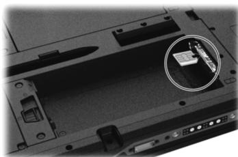
2. El equipo tiene dos compartimentos de batería para dos baterías; cada una se instala de la misma manera.
