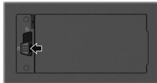
**AVVERTENZA:** Assicurarsi che il fermo della batteria sia bloccato correttamente, e che non si veda la parte inferiore di colore rosso.
