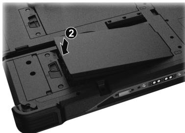
3. Desplace el seguro de la batería hacia la posición de bloqueo (1).
