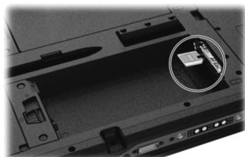
2. Der Computer hat zwei Akkufächer für zwei Akkus, die beide auf gleiche Weise installiert werden.
