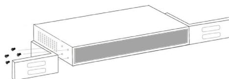
Utilisez les vis fournies avec le rack d'équipement pour monter le commutateur de données Intellinet Network Solutions sur le rack.
