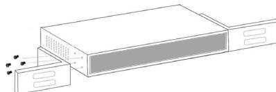
Utilizzare le viti fornite con il rack dell'apparecchiatura per montare lo switch dati Intellinet Network Solutions sul rack.
