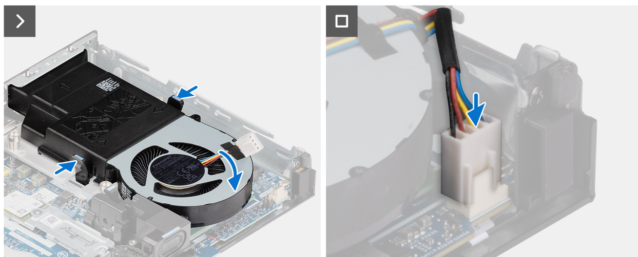
Figure 23. Installing the fan
