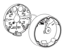
Installing audio/alarm cables
