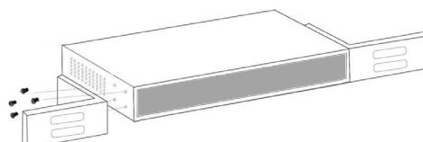
Użyj dostarczonych ze stojakiem śrub, aby przymocować przełącznik Intellinet Network Solutions do stojaka.
