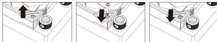
**!** Secure the fan to the radiator and cover with the rubber pads to enhance the overall aesthetics/鎖上水冷排，風扇腳墊可以蓋回去，讓整體更加美觀/Fixez le ventilateur au radiateur et recouvrez-le avec les tampons en caoutchouc pour améliorer l'esthétique globale
