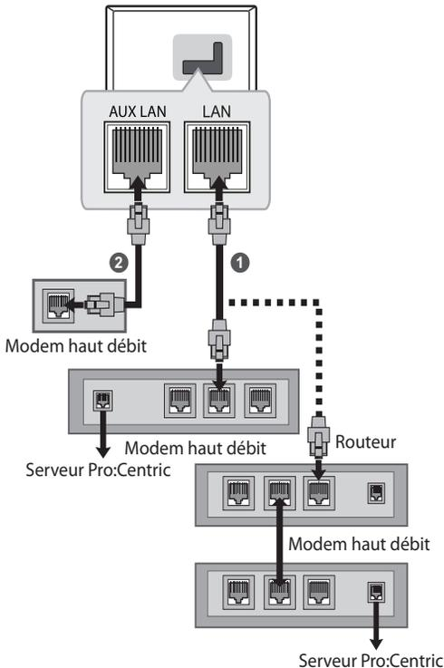
**1** Raccordez le port **LAN** du modem ou du routeur au port **LAN** du téléviseur.
