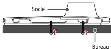
Vis : M5 x L (\* L : profondeur de la table
