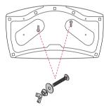
2 vis pour la fixation du socle,
