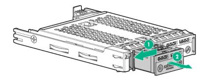
To remove the drive carrier:
