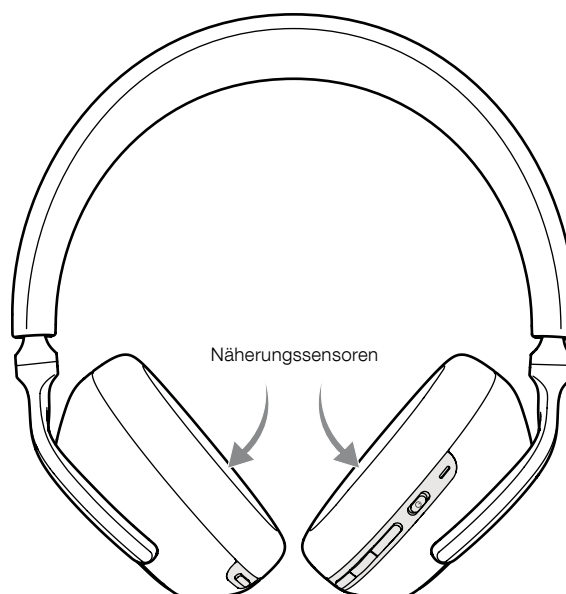
Abbildung 4 Position der Näherungssensoren
