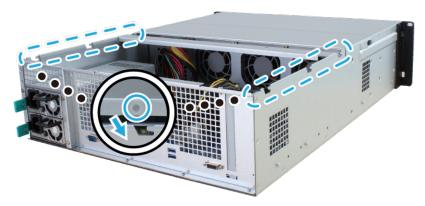
**b** Riposizionare e avvitare la vite rimossa nel passaggio 2-a.
