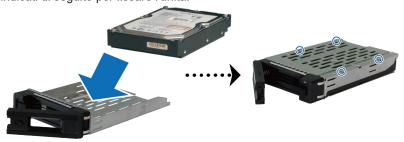
Per unità da 2,5": Posizionare l'unità nel cassetto. Capovolgere il cassetto e stringere le viti nei quattro fori indicati di seguito per fissare l'unità.
