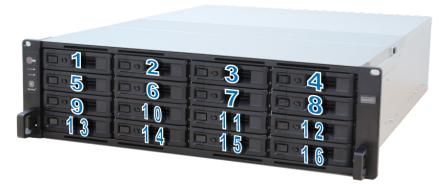
**Nota:** per creare un volume RAID, si consiglia di installare tutte le unità delle stesse dimensioni in modo da ottimizzare l'utilizzo della capacità dell'unità.
