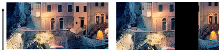
Vorlage und von ausgefallenem Scanbalken betroffener Scan
