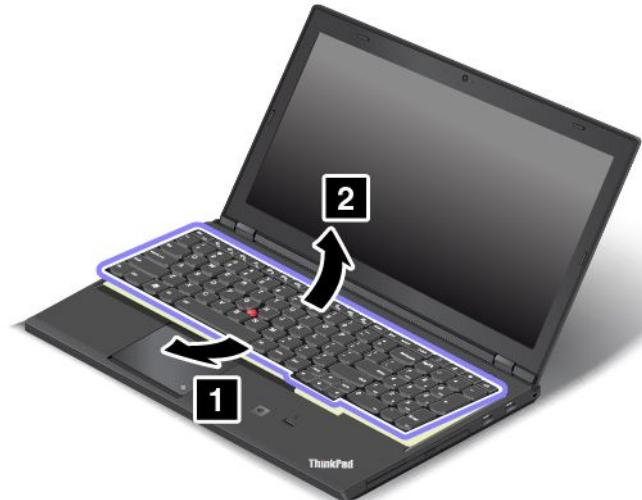
8. Placez doucement le clavier sur le repose-mains, puis débranchez les connecteurs. Retirez ensuite le clavier.
