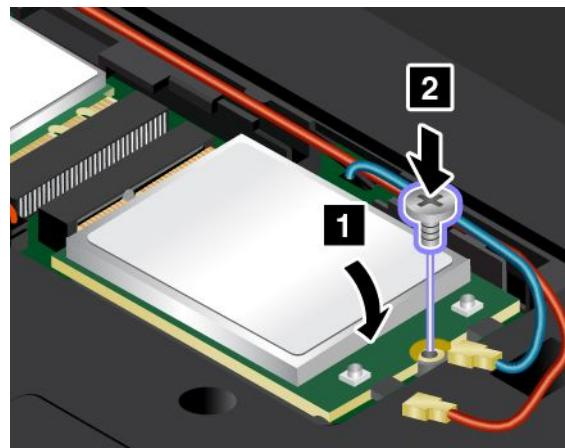
10. Branchez les câbles de l'antenne sur la carte réseau étendu sans fil. Branchez le câble rouge sur le connecteur principal sur la carte et le câble bleu sur le connecteur auxiliaire sur la carte réseau étendu sans fil.
