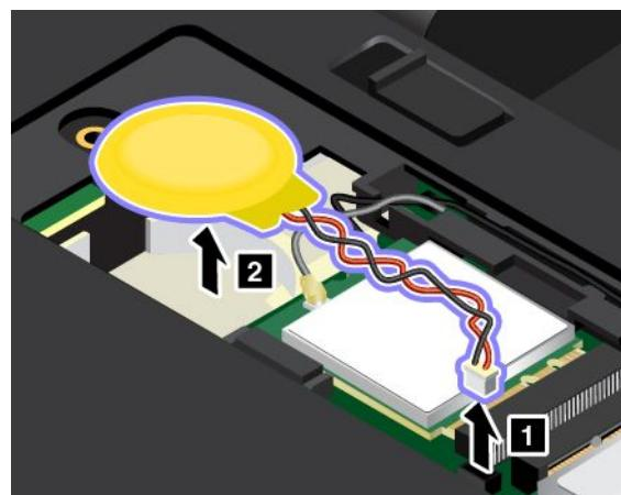
6. Installez la nouvelle batterie à pile cellulaire **1**, puis branchez le connecteur **2**.
