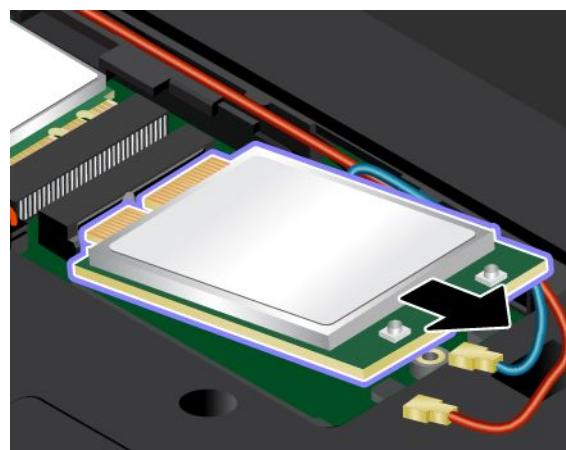
8. Alignez le bord de contact de la nouvelle carte réseau étendu sans fil avec le repère situé dans l'emplacement. Insérez ensuite doucement la nouvelle carte réseau étendu sans fil dans son emplacement selon un angle d'environ 20 degrés.
