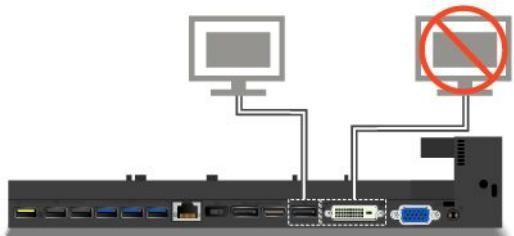
Pour le ThinkPad Ultra Dock, si vous branchez deux écrans sur le connecteur DisplayPort et le connecteur HDMI, le connecteur HDMI est inactif.
