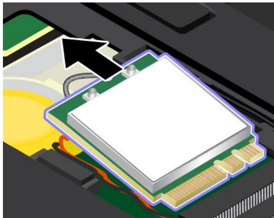
8. Alignez le bord de contact de la nouvelle carte réseau local sans fil avec le repère situé dans l'emplacement. Insérez ensuite doucement la nouvelle carte réseau local sans fil dans son emplacement selon un angle d'environ 20 degrés.
