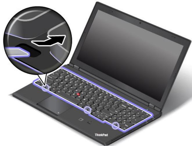
4. Serrez les vis de fixation du clavier à l'aide de l'extrémité cruciforme de l'outil spécial clavier.
