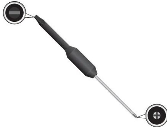
5. Pour faire apparaître les têtes de vis sous le cadre du clavier, faites glisser ce dernier de 2,5 mm vers l'avant à l'aide de l'extrémité plate de l'outil spécial clavier.
