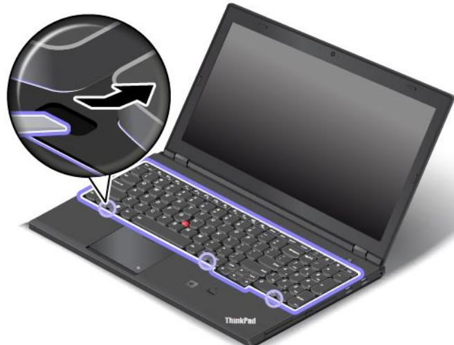
6. Desserrez les vis de fixation du clavier à l'aide de l'extrémité cruciforme de l'outil spécial clavier.
