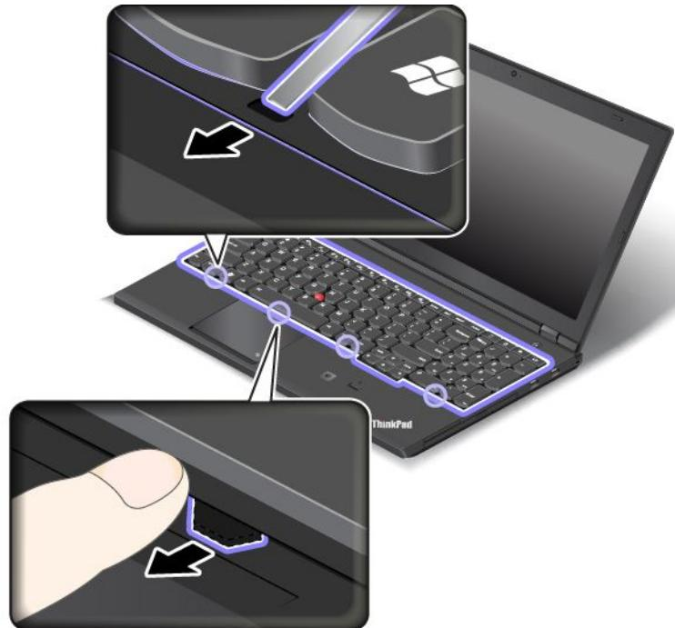
6. Ajustez le cadre du clavier à l'aide de l'extrémité plate de l'outil spécial clavier, pour vous assurer que tous les loquets sont en place sous le panneau du clavier.
