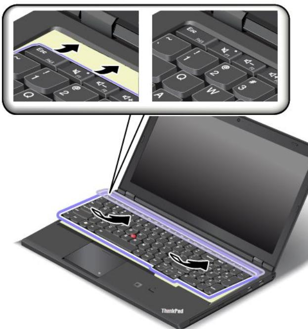
3. Faites apparaître les têtes de vis en faisant glisser le cadre du clavier vers l'avant à l'aide de l'extrémité plate de l'outil spécial clavier. Assurez-vous que les têtes de vis sont entièrement exposées.
