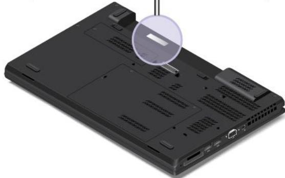
Les étiquettes d'identification FCC et du numéro de certification IC sont apposées sur les cartes réseau local sans fil **1** et réseau étendu sans fil **2** installées dans l'ordinateur.
