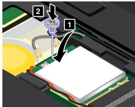
10. Branchez les câbles de l'antenne sur la carte réseau local sans fil. Branchez le câble gris sur le connecteur principal sur la carte et le câble noir sur le connecteur auxiliaire sur la carte réseau local sans fil.
