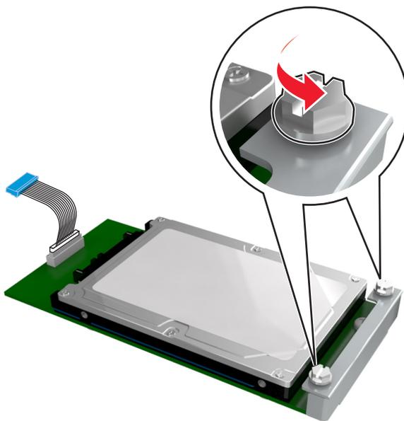
**b** Insérez la fiche du câble de l'interface du disque dur de l'imprimante dans la prise de la carte logique.
