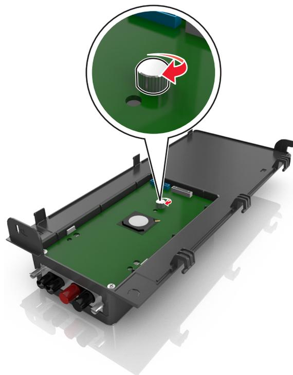
**7** Serrez les deux vis à l'extrémité de la solution ISP.
