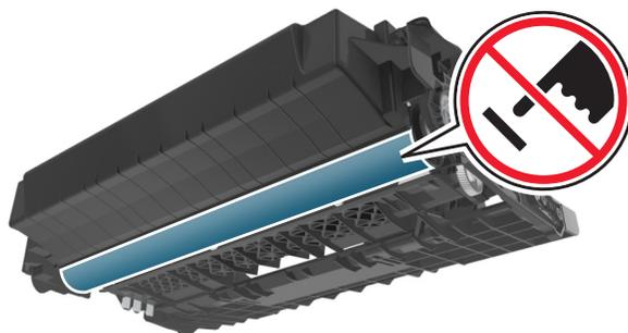
6 Insérez l'unité de traitement d'images dans l'imprimante en alignant les flèches de ses rails latéraux sur celles des rails latéraux à l'intérieur de l'imprimante.
