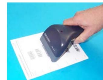
Avec les lecteurs Touch™, la lecture des codes s'effectue automatiquement et par **contact**. Tous les modèles sont doués d'un poussoir qui doit par défaut être appuyé pour lire le code. Après avoir configuré l'interface de lecture, on peut sélectionner le paramètre software trigger (disponible dans ce manuel) pour utiliser le lecteur comme un modèle sans poussoir.
