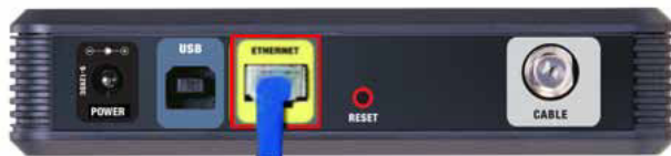
Achterzijde van kabelmodem
