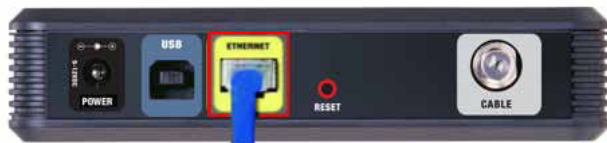
Vue arrière du modem câble
