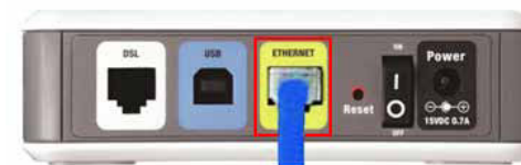
Vista posterior do modem de DSL
