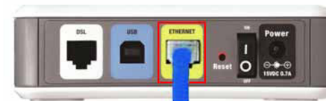
Baksidan av ett DSL-modem
