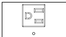
**Salidas NEMA 5-15R (Modelo PDUMNH15):** Durante la operación normal, las salidas distribuyen la energía de CA al equipo conectado.
