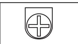
**Vis de mise à la terre :** Utiliser pour brancher tout équipement qui nécessite une mise à la terre du châssis.
