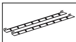
**Estantes de retención del cable (PDUMNH30, opcional):** Cuando están instalados en la PDU, estos estantes ofrecen puntos de conexión seguros para los cables de alimentación de los equipos conectados. Utilice las abrazaderas de cables incluidas para asegurar los cables al estante.
