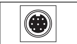
**Port série mini-DIN :** Utiliser ce port pour faire une connexion directe de terminal à un ordinateur avec un programme d'émulation de terminal. Un câble série (pièce no 73-1025) est joint à la PDU. Si vous avez besoin de commander un câble de rechange, appeler le service à la clientèle de Tripp Lite au [www.tripplite.com](http://www.tripplite.com).
