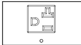
**Salidas NEMA 5-15/20R (Modelos PDUMNH20 & PDUMNH30):** Durante la operación normal, las salidas distribuyen energía de CA al equipo conectado.
