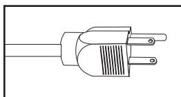
**Cordon d'alimentation d'entrée CA (Modèle PDUMNH15) :** Ce cordon est fixé en permanence à la PDU et dispose d'une fiche NEMA 5-15P.
