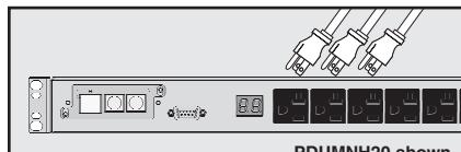
**10 Retención de cable (opcional):** Si ajustó los estantes de retención del cable, utilícelos para asegurar los cables de alimentación de los equipos. Una cada cable al estante de retención enrollando el cable y asegurándolo a un punto de unión con una de las abrazaderas para cables incluidas. Asegúrese de que todos los cables de alimentación de los equipos puedan desconectarse de la PDU sin extraer la abrazadera del cable.
