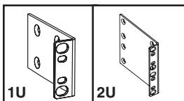
**Soportes para montaje:** Estos soportes desmontables permiten instalar la PDU en una configuración rackmount o debajo del mostrador.
