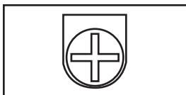
**Tornillo de tierra:** Úselo para conectar cualquier equipo que requiera una conexión de tierra a chasis.
