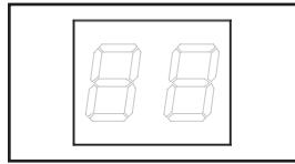
**Medidor digital de carga (Amperímetro, Modelos PDUMNH15 & PDUMNH20):** La corriente eléctrica total usada por la unidad de distribución de potencia (PDU) será mostrada en el medidor digital, en amperios.
