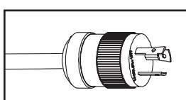
**Cordon d'alimentation CA (Modèle PDUMNH30) :** Ce cordon est attaché en permanence à la PDU et est muni d'une prise NEMA L5-30P.
