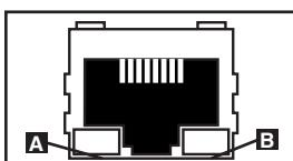
**Puerto Ethernet:** Use este enchufe RJ-45 para conectar el PDU a la red con cable patch Ethernet estándar. El LED de Encadenamiento **A** y el LED de Estatus **B** indican varias condiciones de operación de acuerdo a lo mostrado en la tabla abajo. *Nota: Este puerto no es compatible con la aplicación PoE (Power over Ethernet / Energía sobre la Ethernet).*
