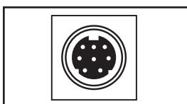
**Puerto Serial Mini-DIN:** Use este puerto para obtener una conexión Terminal directa a una computadora con un programa de emulación Terminal. Un cable serial (parte número 73-1025) se incluye con el PDU. Si necesita ordenar un cable de reemplazo comuníquese al Soporte a Clientes de Tripp Lite al [www.tripplite.com](http://www.tripplite.com).
