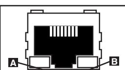
**Port Ethernet :** Utiliser cette prise RJ-45 pour connecter la PDU au réseau à l'aide d'un cordon de raccordement standard Ethernet. La DEL de lien **A** et la DEL de statut **B** indiquent plusieurs conditions de fonctionnement, comme le montre le tableau ci-dessous. *Incompatible avec les applications PoE (Power Over Ethernet).*
