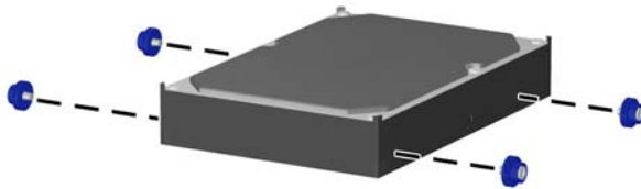
Figure 2-26 Installation des vis de guidage sur le disque dur
