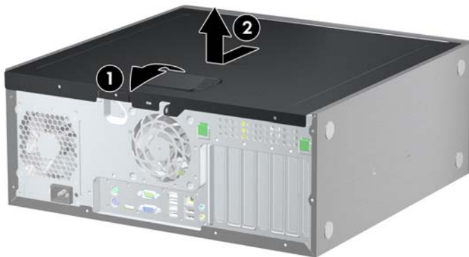
Figure 2-2 Retrait du panneau d'accès de l'ordinateur
