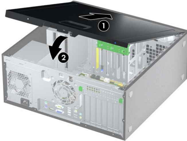
Figure 2-3 Remise en position du panneau d'accès de l'ordinateur
