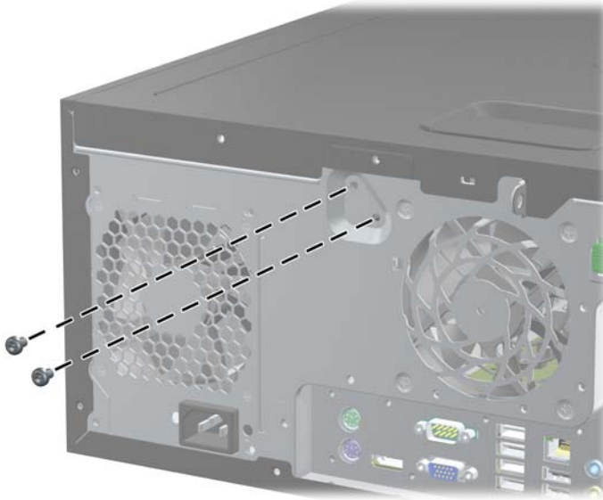
Figure 2-1 Retrait des vis du verrou Smart Cover
