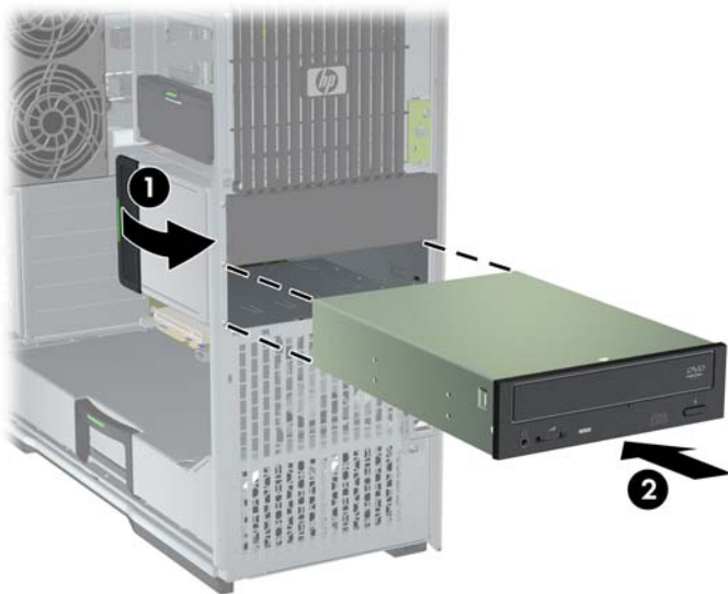
Figura 10-4 Installazione dell'unità ottica
