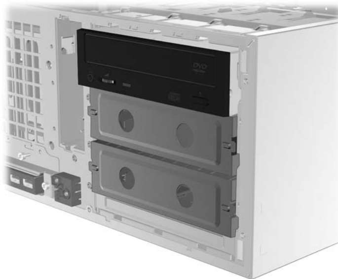
Figura 3-7 Reinstallazione dell'unità ottica
