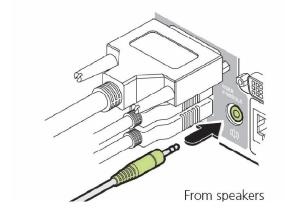
FIGURE 3-6. CONNECTING SPEAKERS TO THE USER CONSOLE
