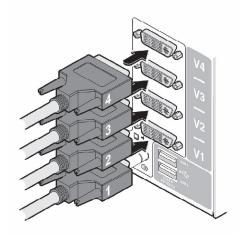
FIGURE 3-9. CONNECTING MUTLIPLE VIDEO OUTPUTS TO THE DVI-I PORTS
