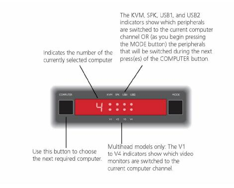
FIGURE 5-1. FRONT-PANEL BUTTONS
