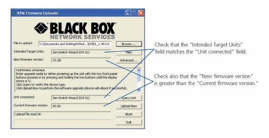
FIGURE 4-2. SELECTING THE UPGRADE FILE FROM THE KVM FIRMWARE UPLOADER WINDOW
