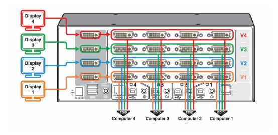
FIGURE 3-18. MULTISCREEN CONFIGURATION
