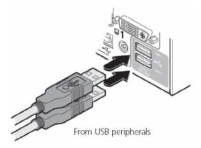
FIGURE 3-2. CONNECTING THE KEYBOARD/MOUSE TO THE USER CONSOLE
