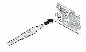
FIGURE 3-11. CONNECTING THE POWER ADAPTER
