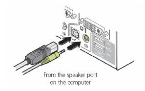
FIGURE 3-7. CONNECTING A COMPUTER UNIT TO THE WIZARD DVI DL UNIT.
