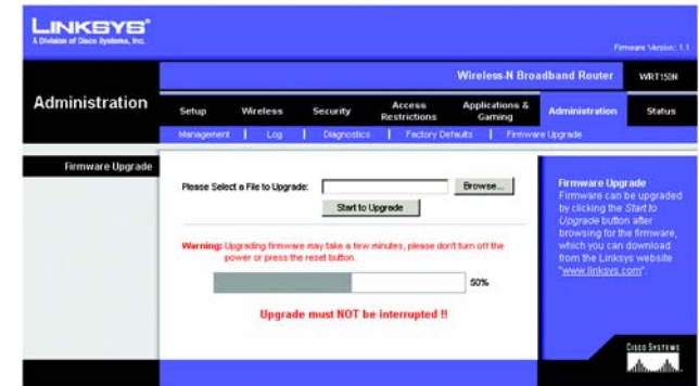
Figura C-1: Firmware Upgrade (Actualización del firmware)
